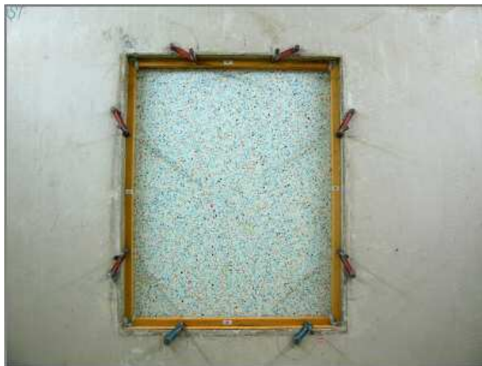
Deska ALD50 zabudovaná ve zkušebním panelu
